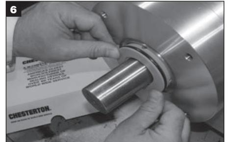
6 Die Scheibe entfernen und die Dichtung gleichmäßig in die Bohrung drücken.
