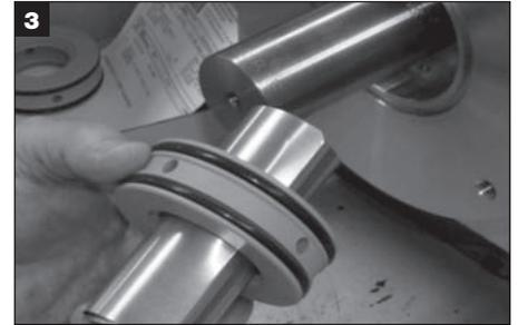
3 Die Scheibe drehend durch die Dichtung durchführen.
