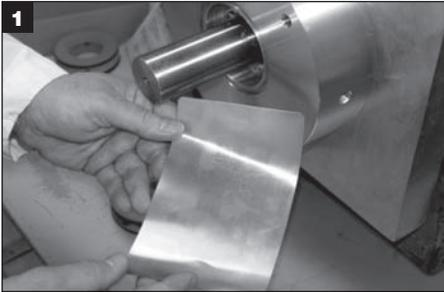
1 Eine 0,127 mm dicke Messingscheibe zuschneiden, die ca. 6 mm größer als der Wellendurchmesser ist.
