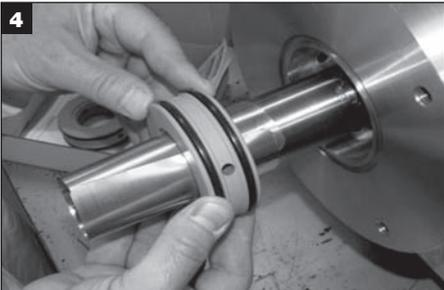
4 Die Scheibe und Dichtung auf die Welle aufschieben.
