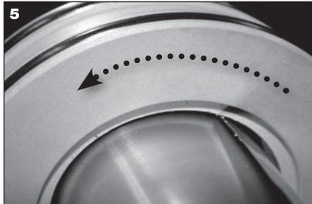
5 Die Dichtung in die Richtung der Scheibenüberlappung drehen und auf die Welle aufschieben.
